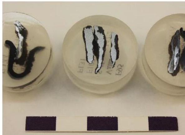
Figur 2. Polerprov på de snitt från holken på respektive ämnesjärn som har analyserats. Från vänster till höger: Fynd 144, 131, 103, 95 och 104.
