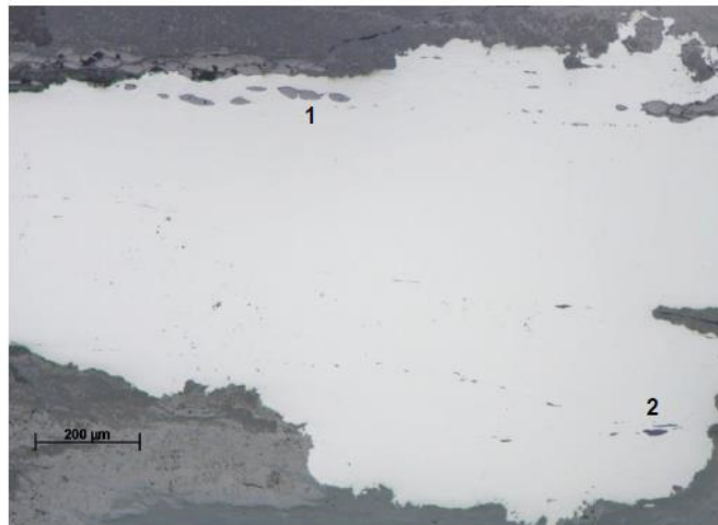
Figur 14. Fynd 104. Foto från mikroskopet på polerad yta; detalj från övre delen i föregående figur på slagginneslutningar. I de övre (1) ses främst wüstit (grå). I några av de nedre (2) ses små mörkare ytor som är en glasfas.
