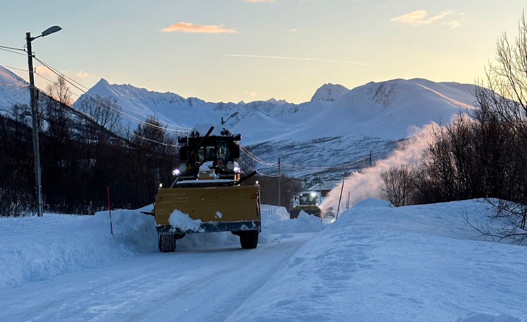
Veghøvel har vært viktig for å brøyte vegene i hele Norge. Fresen er kommet til i senere år. Her fra Lyngen i Troms. (Foto: Silje Magnetun Merødningen)
