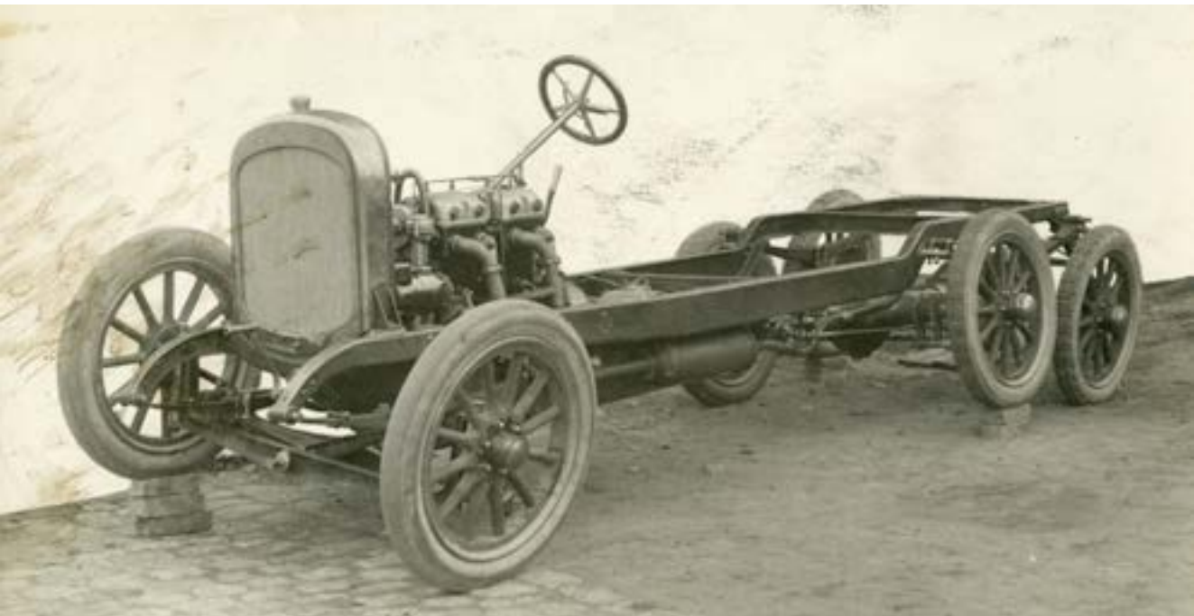
Et bilde av Mustads bil under bygging i 1917. Chassiset ble bygget i verkstedet til Mustad og Søn, og så påsatt et karosseri bygget ved O. Sørensens Værksteder. (Foto H Brinchmann, Kristiania)
