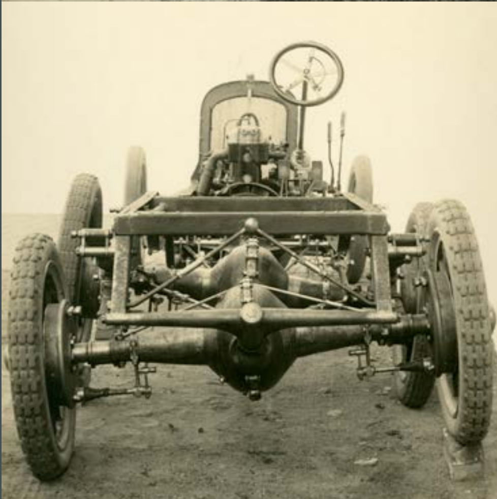
Bildet av et ferdig understell før karosseriet ble satt på i 1917 viser den patenerte konstruksjonen med oppheng som gjør at bakakslene kan bevege seg uavhengig av hverandre. Øverst familien på tur i åpen bil. (Foto fra Mustad-familien)
