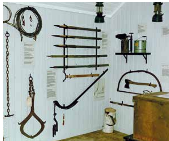
Redskaper til å ta opp bunntømmer: en bunntømmersaks og fem ulike bunntømmerhaker. Vanligvis er skaftet fire til seks meter langt. Foto: Fetsund Lenser
