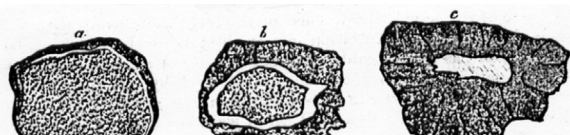
Fig. 3. 3 trinn ved kjernerøsting, etter Percy (1861): a – råstoff b – skrov, kjerne og uomdannet kis c – produkt med kobber og svovel i kjernen, skrov med jernoksyd på overflaten.
