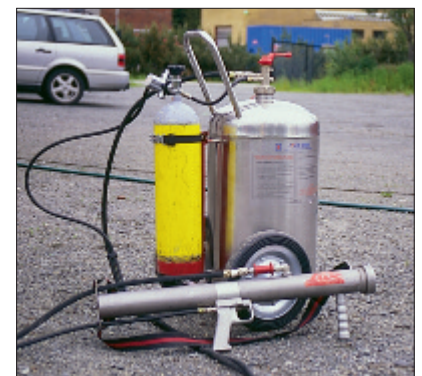
Bildet viser tåkeskuddgevær på hjul. Et brannsløkkingsverktøy som rekker langt, bruker lite vann og slokker effektivt. Foto: Sjur Helseth, Riksantikvaren.
