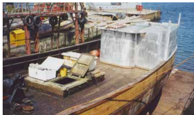
Gamle styrehuset er fjernet og den ny keising monteres hos Kvernhusvik Skipsverft, foto: Willy Eide
