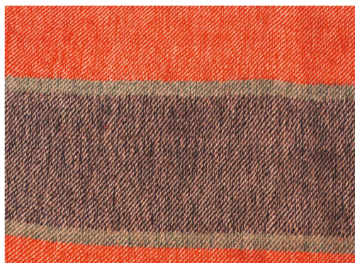
Fellplagg (infomanten brukte uttrykket "fellvar") vove av Kjerstina Olsdtr. Strømsås f. Sivildal (1867-1958) Bindinga er innslagskypert, frå gammalt kalla "botntrødd". Her vises forskjell på rett og vrangside. (Foto: forf.).
