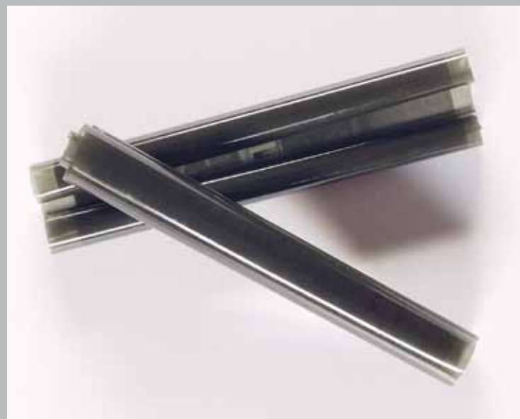
Eksempel på degradert og sprukket negativ. Foto: Roderick Ewart, Akershus fylkesmuseum
