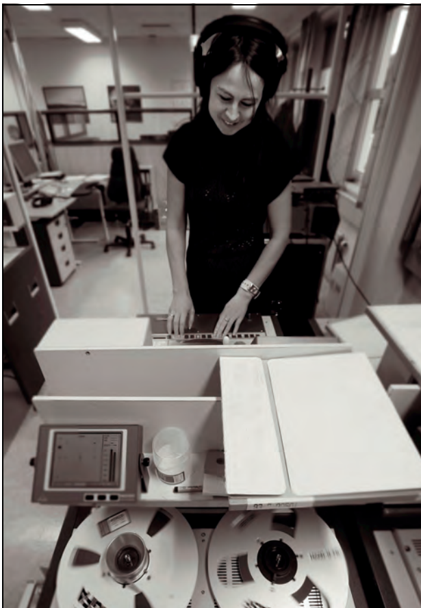
Figur 5.3 Kvarttom-bånd fra NRKs historiske radioarkiv klargjøres for digitalisering.
