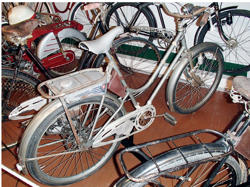
Tempo Victoria. Tempos første moped, 1951 – 1953. Med motoren ved bakhjulet.
