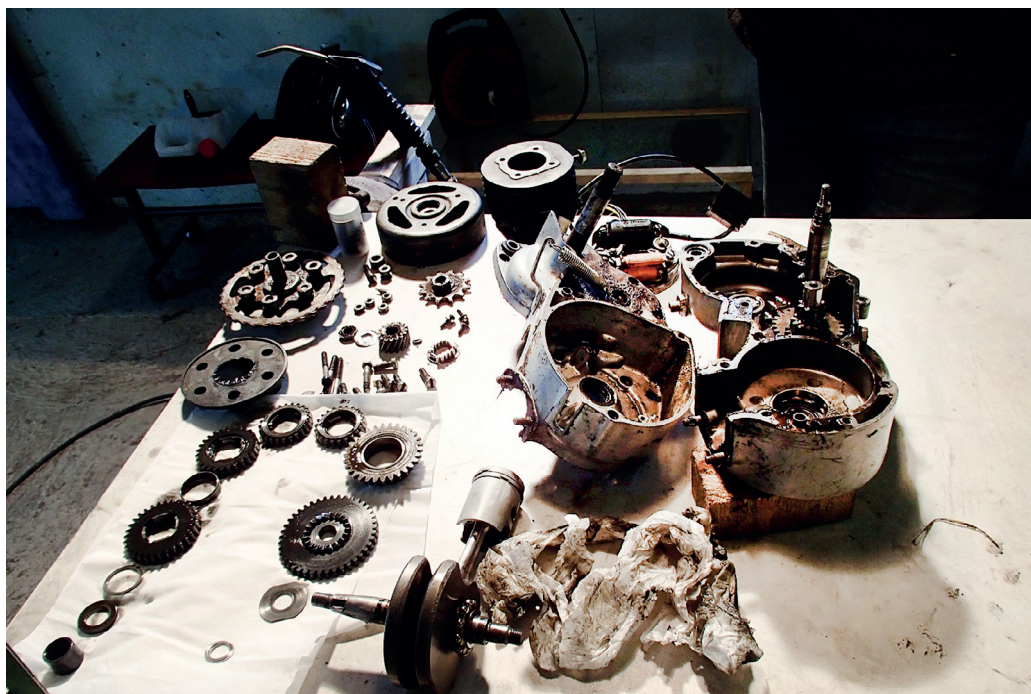
Corvette-motor, delt opp i de fleste deler.
