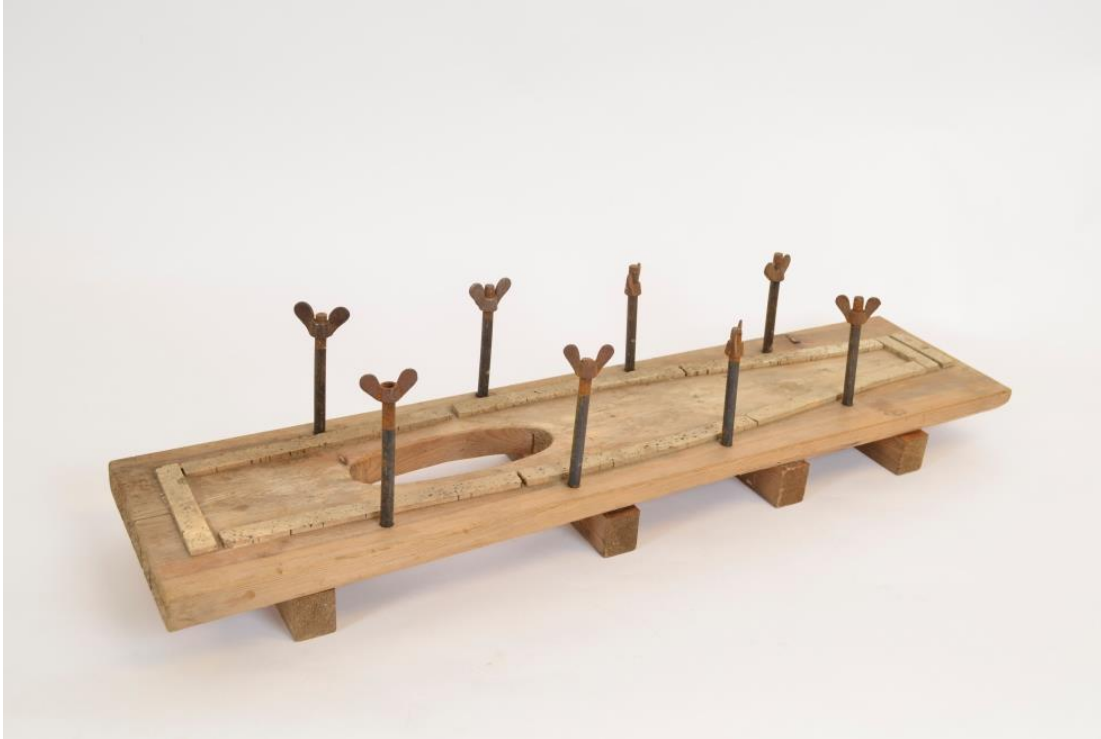
Inntak 2021: Verktøy frå langeleikmakarverkstaden Røsshauken i Øystre Slidre. Tvinge for liming av lok eller botn på langeleik (VFF 20591). Foto: Valdresmusea.
