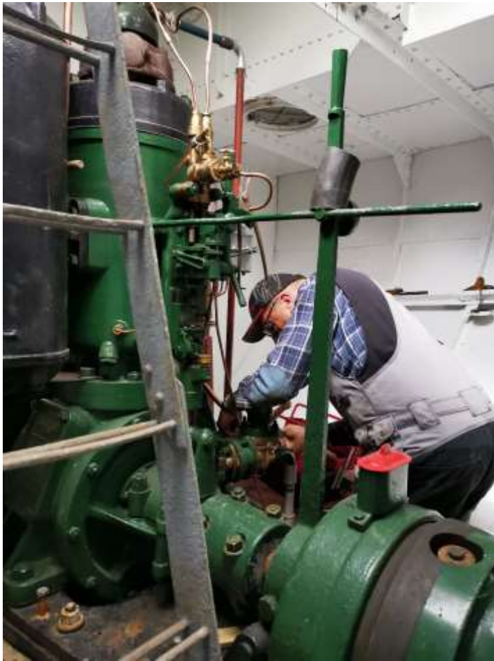
Lennart Bildengjerdingen, frivillig, jobber med justering av drivstoffsystemet.
