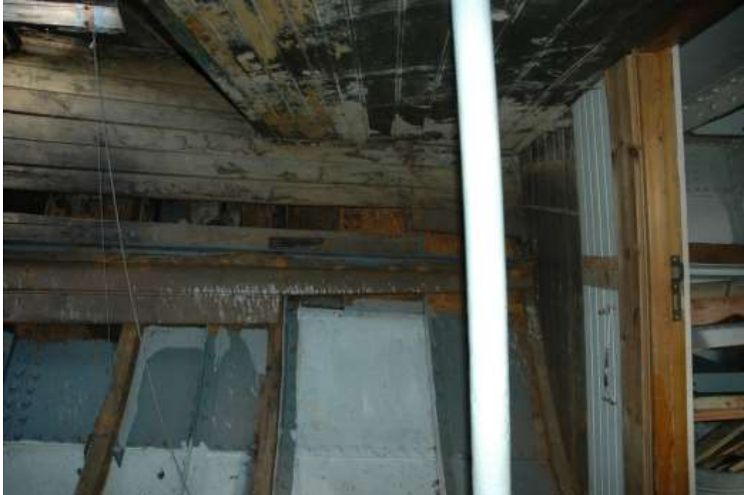
Spesielt SB side var skadet og manglet garnering i 2015. Foto M.Hjelløy
