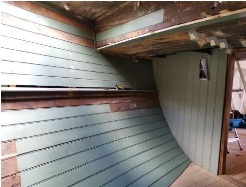
Over og under. Garneringen SB side mot skott. Det var lite av de originale bordene som var i god nok stand til å brukes om igjen. Mesteparten av bordene under livholten manglet i 2015.
