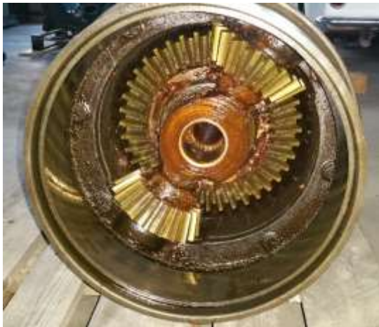
Giret ble heist ut og demontert i september for feilsøking. Her thrustlager som trolig må maskineres.
