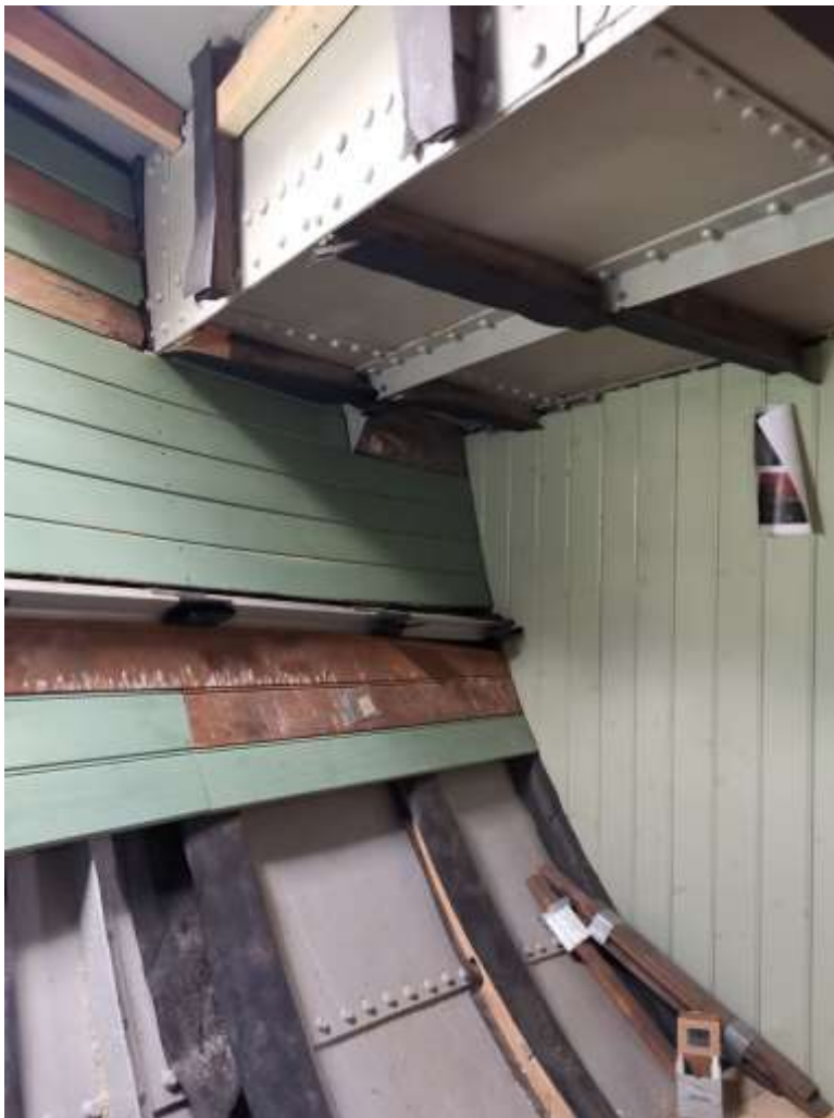
Over og under. Garneringen SB side mot skott. Det var lite av de originale bordene som var i god nok stand til å brukes om igjen. Mesteparten av bordene under livholten manglet i 2015.
