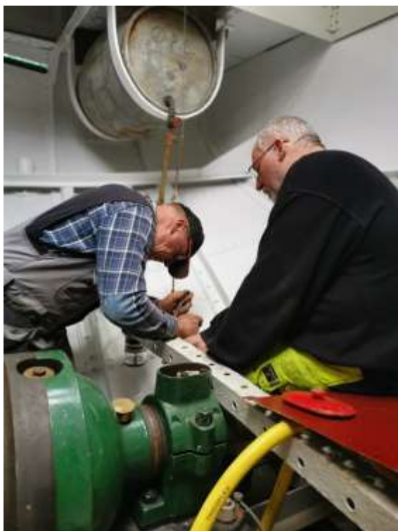
Lennart Bildengjerdingen monterer drivstoffsystemet, Olav Hasle bistår. Begge er frivillige i venneforeningen og med høy kompetanse på motor og maskin.
